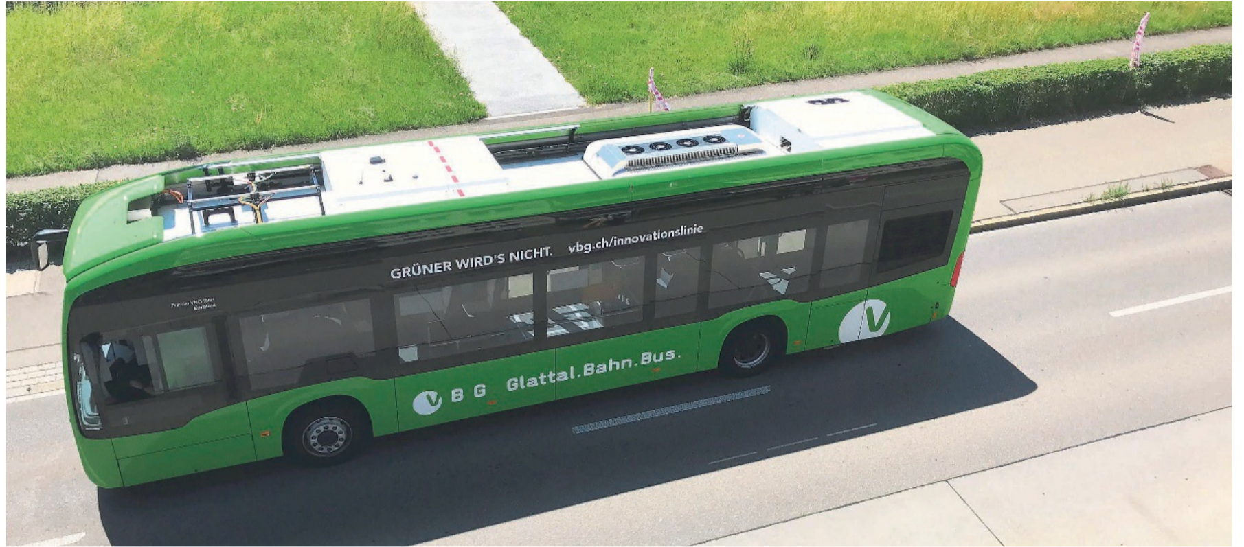
10 bis 15 Prozent der Energie wenden die grünen Elektrobusse fürs Kühlen auf. Das ist deutlich weniger als bei einem Personenwagen mit Klimaanlage mit 30 Prozent.
