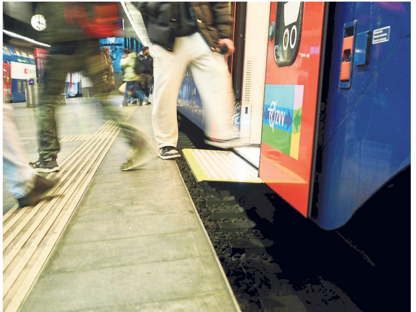
Noch klafft zwischen Perronkante und Trittbrett eine Lücke. Diese wird in den nächsten Wochen geschlossen.
