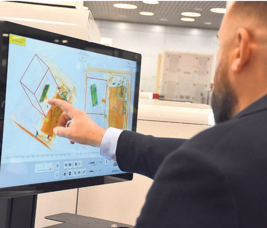
Auffälligkeiten werden in 3D-Ansichten des schichtweise durchleuchteten Gepäcks analysiert.
