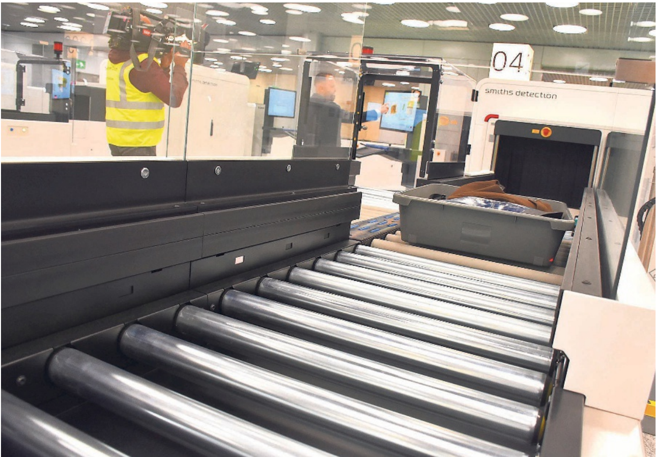
Nach dem CT- Scanner wird die Wanne mit dem Gepäckstück direkt zur Ausgabe geführt oder zur weiteren Kontrolle umgeleitet. BILDER THOMAS GÜNTERT
